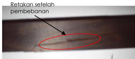
Gambar 4. Spesimen uji yang telah diuji
