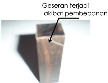
Gambar 2. Spesimen uji setelah diuji
