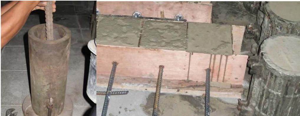
Gambar 1. Pengecoran Benda Uji
