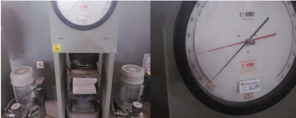
Gambar 6. Pengujian Tekan Batako
